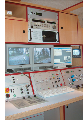
Bild 2: Innenleben eines Kanalinspektionsfahrzeuges
