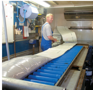
Füllen des Schlauches mit einem aushärtbarem Harzgemisch.
